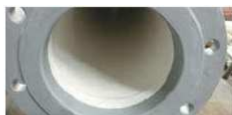
Pred aplikáciou, počas aplikácie a po aplikácii systému Belzona 1381 striekaním na vnútorný povrch potrubia
