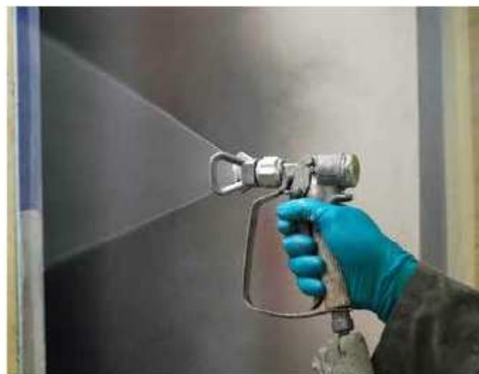
Produkt Belzona 1381 môže byť striekaný so zanedbateľným opotrebovaním trysky
