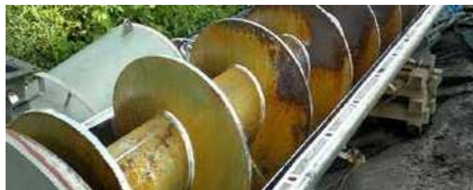
Poškodený závitovkový dopravník
